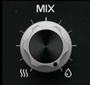
MIXノブは、WET 信号と DRY 信号のブレンドを制御します。
