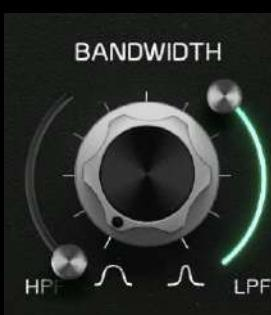
BANDWIDTH、HPF、LPF は連携して、モジュールの処理された (WET) 信号用のバンドパスフィルターを形成します。HPF と LPF がフィルターの端点を設定し、BANDWIDTH ノブがそれを微調整して、ミックスに完璧にフィットするエフェクトを作り出します。
