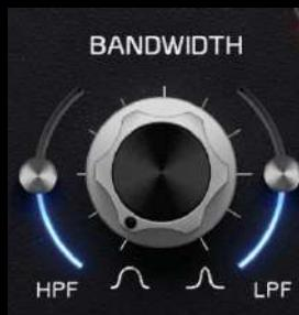
BANDWIDTH、HPF、LPF は、Plate REVERB 信号のために単一のバンドパスフィルターを形成します。HPF と LPF がフィルターの端点を設定し、BANDWIDTH ノブがそれを微調整して、ミックスに完璧にフィットするエフェクトを作り上げます。
