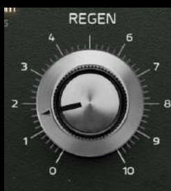
REGEN ノブは、遅延信号の一部が Delay Line の始まりに Feedback される回数を制御します。このダイヤルを 8 以上に設定すると、ランアウェイ効果が得られます。この効果には注意が必要で、出力レベルが内部クリッピングに達するまで増加し続ける可能性があります。
