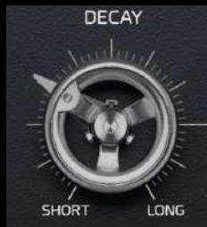
DECAY は、Reverb 音が消えていくまでの時間を制御します。これは非常にスムーズな 4段階の Decay Process を使用して実装されています。Decay Time は、選択した PLATE SIZE に大きく依存します。DECAY に加えて、聞こえる Reverb Tail は DAMPING によっても大きく影響を受けます。機械的なハードウェアと同様に、異なるパラメーターで試しながら、オーディオがどのように影響を受けるかを聴いて感じることが重要です。
