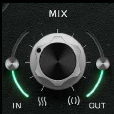
MIXノブは、BBDで処理された信号と入力信号のブレンドを制御します。入力信号は、Moduleが直列に設定されている場合の BBD の位置によって定義されます。
