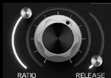
**Tip:** P930 をコンプレッサーとして使用します！ BBD および PLATE REVERB モジュールをバイパスし、DKG 回路を DUCK に設定し、DKG ルーティングオプションを OUT に設定します。
