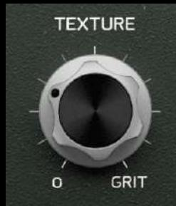
TEXTURE は REGEN が Delay Line に Feedback する際に変化する BBD 回路の歪みと Grit を増幅します。これにより、美しい Slapback Echo からサイケデリックな SF 効果までの幅広い結果が得られます。TEXTURE は Clean から Warm、Grit まで調整できます。
