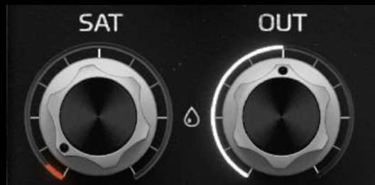
SAT P42 サチュレーションは、OUTPUT モジュールに到達する信号に適用されます。これは WET 信号に適用され、ドライ信号には適用されません。
