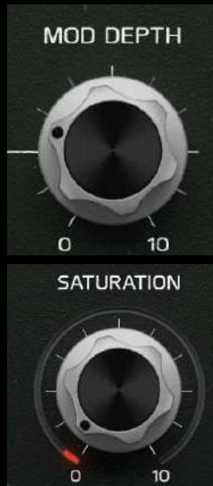
Modulation Depth ノブは、Delay に適用される LFO の振幅を制御し、ピッチ変化の量に影響を与えます。このノブがゼロの状態では、Modulation Rate だけでは信号に影響を与えることはできません。
