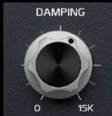
DAMPING は、Plate Reverb で使用される機械的メカニズムを模倣し、Reverb 信号内の高周波成分を吸収します。選択した周波数以上のすべての周波数が吸収対象となります。
