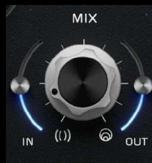
ノブは、PLATE REVERB で処理された信号と入力信号のブレンドを制御します。
