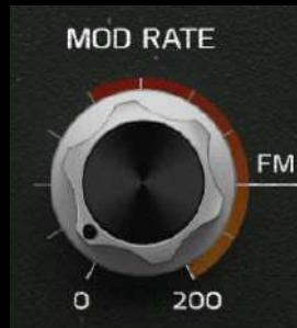
MOD RATE ノブは、Delay Line に適用される低周波オシレーション (LFO) のレートを制御し、MOD DEPTHが0でない場合にはピッチ変化のスピードに影響を与えます。これにより、ディレイ信号に様々なエフェクトが生まれ、コーラスやビブラートから FMベルのような音まで幅広い効果を得られます。1 Hzまでの周波数では、ピッチがゆっくりと揺れ、サブトラクティブシンセシスの LFOのような効果が得られます。1 Hzから20 Hzの間では、ビブラート効果が生成されます。20 Hzを超える周波数では、LFO自体が聞こえるようになり、粗く非和音的なトーンが生じます。
