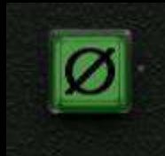
Polarity Flip は、MIX ノブの前で信号の極性を反転させます。極性を反転させることで、Delay Line の位相問題を修正したり、意図した効果を強調したり、サウンドデザインでのクリエイティブな可能性を広げることができます。
