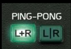
L+R は標準のステレオ PING-PONG ディレイで、遅延信号が左右の信号を組み合わせ、最初に 1 つのチャンネルで現れ、その後反対のチャンネルにバウンスすることでリズミカルな往復運動を生み出します。Echo はステレオフィールド全体にブレンドされ、広がりのあるダイナミックなリスニング体験を提供します。
