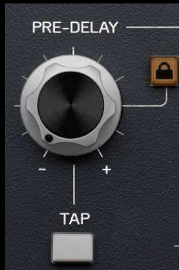
PRE-DELAY は、最初の音が終わってから最初の反射音が聞こえるまでの時間であり、これにより初期アタックがミックスの中でしっかりと際立つようになります。Pre-Delay 時間を調整することで、空間的な特性を強調しつつ、ソース音の明瞭さや輪郭を損なわないバランスを実現することができます。
