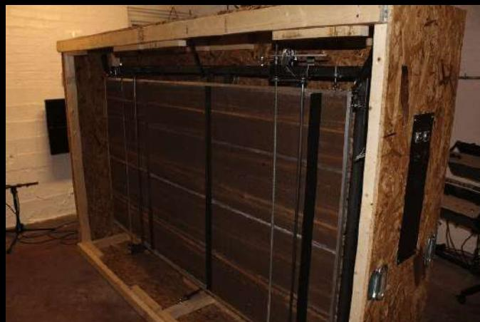
1957 年以前、自然な残響音を録音するには、特別に設計された部屋で録音し、マイクの配置を工夫して空間感を伝える必要がありましたが、不要な周波数や位相のキャンセルを避けるのは困難でした。この問題に応えるため、ドイツの EMT 社は、画期的な電気機械式残響装置である EMT 140 を開発しました。この大きな振動板を内蔵した装置は、スタジオ録音において革命を起こし、1970 年代から 1980 年代にかけてデジタルによるプレートリバーブの再現が登場するまで、スタジオ録音の基盤となりました。
