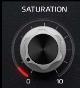
SATURATION は P42 Climax 回路によって駆動されています。これは Module 特有のもので、PLATE 処理された信号にのみ適用されます。サチュレーションルーチン は Reverb に対して顕著な効果をもたらし、増加するにつれて強いインパクトと重みを与えます。
