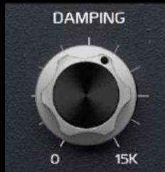
Das DAMPING ahmt die Mechanik nach, mit der die Hochfrequenzen des Plattenhalls absorbiert werden. Alle Frequenzen oberhalb des eingestellten Parameters werden gedämpft.
