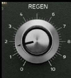
Mit dem Regler REGEN legen Sie fest, wie oft ein Echo wieder an den Anfang der *Eimerkettenschaltung* zurückgeführt werden soll. Stellen Sie den Regler auf 8 oder höher, wird ein fortlaufender Effekt ausgelöst, der ein permanentes Feedback generiert. Gehen Sie daher bitte mit Bedacht vor: Diese Anwendung kann die Lautstärke so lange anheben, bis es zum Clipping kommt.
