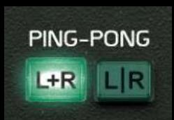
L+R - ein gängiges Ping-Pong-Delay. Es kombiniert das rechte und das linke Signal miteinander. Das zuerst auf einem Kanal erfasste Signal wird auf den gegenüberliegenden Kanal geworfen, wodurch ein rhythmischer Wechsel entsteht. Die auf diese Weise im Stereofeld verteilten Echos vermitteln ein dynamisches Gefühl für Raum und Zeit.
