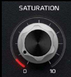
SATURATION ist die Sättigungseinheit unseres P42 Climax'. Da sie bloß innerhalb des jeweiligen Moduls wirkt, sättigen Sie mit ihr ausschließlich das Nass-Signal des Plattenhalls. Darauf hat die Sättigungseinheit einen markanten Effekt: Je mehr Sie das Signal sättigen, desto mehr Gewicht und Durchsetzungsvermögen erhält es.
