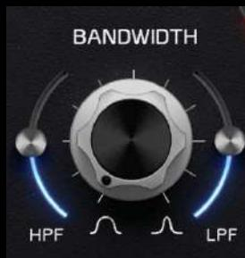
Gemeinsam formen die Bedienelemente BANDWIDTH, HPF und LPF ein einzelnes Bandpass-Filter, mit dem Sie die Bandbreite des Effektsignals begrenzen können. Mit dem Hochpass- (HPF) und Tiefpassfilter (LPF) legen Sie die Endpositionen des Filters fest, indessen nehmen Sie mit dem Regler BANDBREITE (BANDWIDTH) die Feinabstimmung vor, um das Effektsignal perfekt in Ihre Mischung einzubetten.
