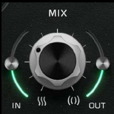
Mit dem Regler MIX mischen Sie im Modul BBD das Effektsignal mit dem Eingangssignal. Verwenden Sie die Serienschaltung, kann sich, Je nach Position des BBD-Moduls, das Eingangssignal wie folgt verändern:
