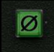
Dieser Schalter dreht die Polarität des Effektsignals. Im Signalpfad haben wir ihn vor den Schaltkreis MIX platziert. Durch das Drehen der Polarität können Sie Phasenprobleme in der Delay-Kette korrigieren, den eigentlichen Effekt aber auch verstärken. Damit erweitern Sie Ihre Möglichkeiten für Klangbasteleien.
