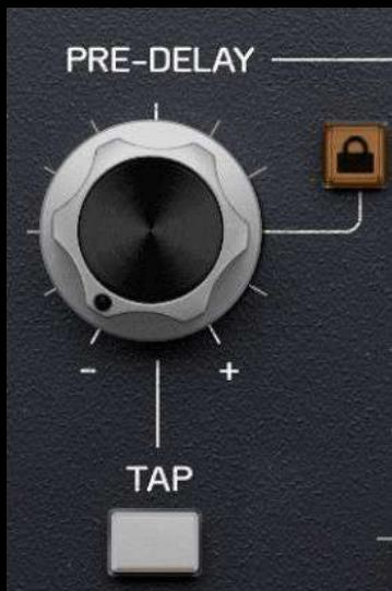
Mit dem PRE-DELAY, der Vorverzögerung, legen Sie fest, wie lange es dauert, bis nach dem Eingang eines Signals die Erstreflektion des Plattenhalls erklingt. Damit halten Sie die Anschlagtransiente frei von Hall, sodass sie sich in Ihrer Mischung besser durchsetzen kann. Durch diese Vorverzögerung schaffen Sie eine Balance, die die Abbildung im Raum verbessert. Dabei bleibt die Klarheit und Klangschärfe der Tonquelle erhalten.
