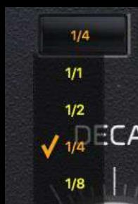
Dem PRE-DELAY weisen Sie eine TAKTUNTERTEILUNG zwischen zwei Schlägen zu, indem Sie einen musikalischen Intervall im Untermenü wählen. Dabei bleibt die Position des Reglers PRE-DELAY stets unverändert. Haben Sie dem PRE-DELAY 20 ms zugewiesen, entspricht das im  $\frac{1}{4}$ -Takt 10 ms und 40 ms im  $\frac{1}{2}$ -Takt.
