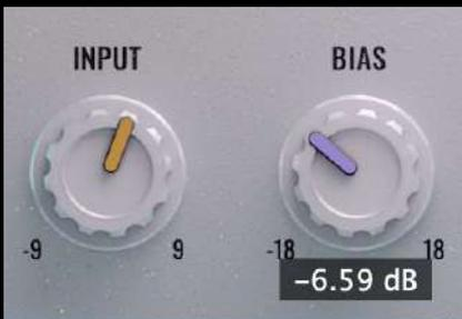
**INPUT:** Der Eingangsverstärker steuert die Pegelmenge, die den gekoppelten Transformator speist. Niedrigere Einstellungen halten das Signal klarer, höhere erzeugen mehr Obertöne. Das färbt das Signal und formt es, bevor es von der Kompressoreinheit erfasst wird. Der Eingangsverstärker ignoriert das Signal im Sidechain-Kanal, mit ihm gestalten Sie ausschließlich den Klang.
