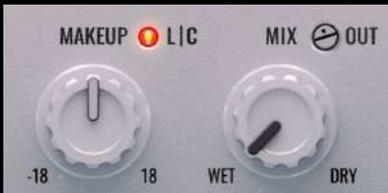
**MAKEUP:** Damit gleichen Sie die Pegeländerung am Ausgangskanal aus, die durch die Kompression und der Schaltung TX IN entstanden ist.
