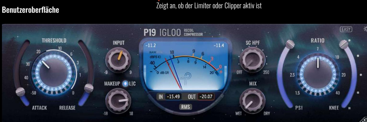
**THRESHOLD:** Damit richten Sie den Schwellenwert im Detektor ein. Überschreitet ein Signal diese Grenze, reduziert der Kompressor seinen Pegel. Der Detektor selbst hört ausschließlich auf das Sidechain-Signal (intern oder extern).
