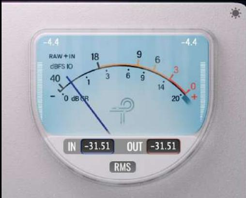
**PEAK-Messung:** Liest den Durchschnitt der Spitzenpegel des linken und rechten Kanals aus und visualisiert die Werte mit den beiden Nadeln für den Ein- und Ausgang. Unterhalb des VU-Fensters lesen Sie die exakten Messungen der Pegelspitzen in Zahlenwerten ab.
