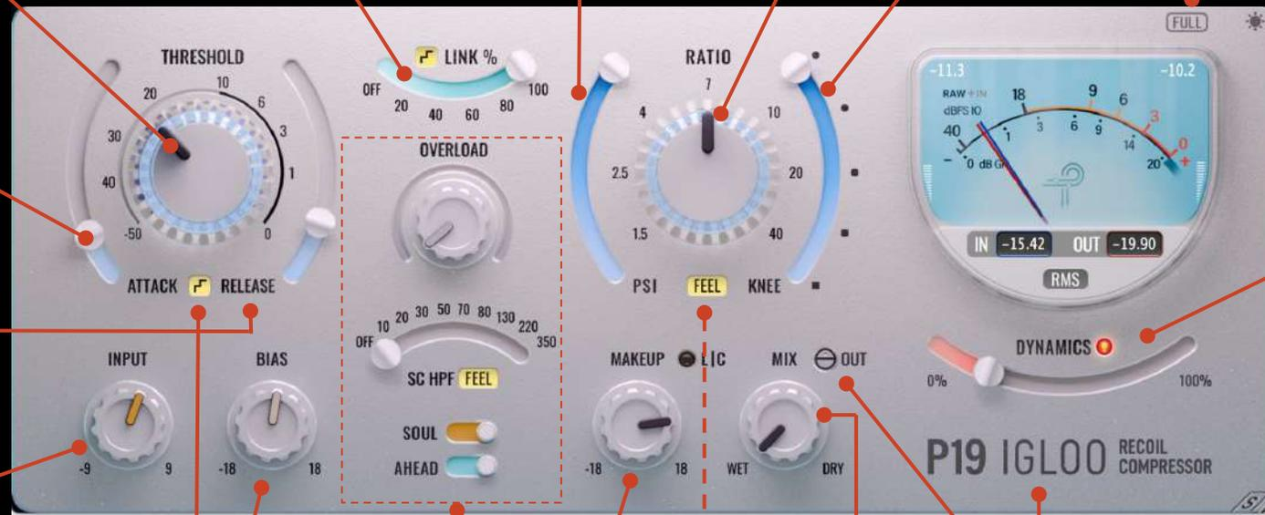
**MAKEUP:** Zum Ausgleichen der Pegeländerungen im Ausgangskanal, die durch die Kompression entstehen.
