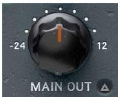
Der Ausgangsverstärker MAIN OUT arbeitet rein digital. Er verstärkt oder dämpft das Signal auf einer Skala von -24 bis 24 dB. Gerade die hohen Minuswerte sind von Nutzen, zumal für den Pegelausgleich, falls Sie den Regler INPUT DRIVE aufdrehen, um die Dichte der Obertöne zu erhöhen.
