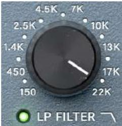
Das handgemachte Tiefpassfilter hat eine Sperrdämpfung von 12 dB/Okt. Je nach der Host-Abtastrate ändert sich die Maximalfrequenz wie folgt:
