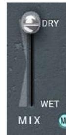
Mittels des Schiebereglers MIX mischen Sie das bearbeitete nasse Signal mit der gewünschten Menge des unbearbeiteten, trockenen Signals zusammen. Das Gemisch wird dann direkt in den Ausgangsverstärker MAIN OUT gespeist.
