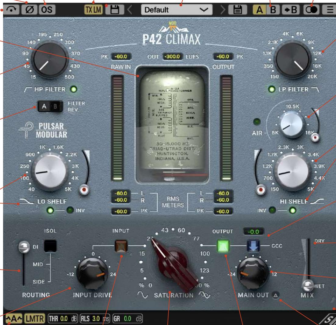
**LP-FILTER** – Das Tiefpassfilter hat eine Sperrdämpfung von 12 dB/Okt. Es ist ein- und ausschaltbar, indem Sie auf das grüne LED-Lämpchen klicken.
