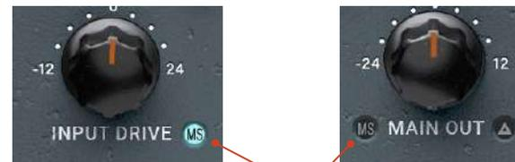
Sobald das ROUTING auf M/S steht, erscheinen neben den Reglern INPUT DRIVE und MAIN OUT beleuchtete M/S-Taster. In diesem Fall werden beide Regler fortan motorisiert gesteuert. Dazu später noch mehr.
