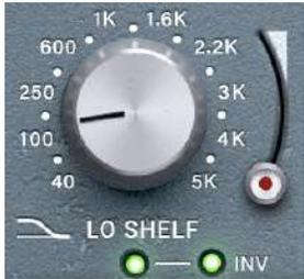
Mit diesem Filterschaltkreis betreiben Sie wahlweise ein Niederfrequenzfilter, das LO SHELF, oder das proportional-Q- beschaffene Glockenfilter. Sie wechseln den Filtertyp, indem Sie auf seine Beschriftung klicken.
