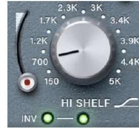
Mit diesem Filterschaltkreis betreiben Sie wahlweise ein Hochfrequenzfilter, das HI SHELF, oder das proportional-Q- beschaffene Glockenfilter. Sie wechseln den Filtertyp, indem Sie auf seine Beschriftung klicken.
