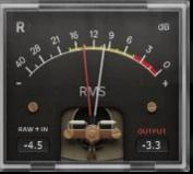
P455 の VU メーターは、ショートターム (RMS) の平均入力 と出力レベルを表示すること知覚される音量の微妙な表現を 提供します。ピーク値はメーターの下部四角に表示されます。
