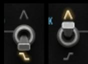
Die links und rechts außen befindlichen Frequenzbänder können Sie wahlweise als Glockenfilter (engl.: peak filter), oder als Filter mit Kuhschwanzcharakteristik (engl.: shelf filter) nutzen, indem Sie den Kippschalter in die gewünschte Position bringen. Kippen Sie den Schalter für die Auswahl Glockenfilter nach oben und für das Filter mit Kuhschwanzcharakteristik nach unten.
