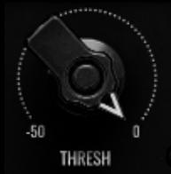
Der THRESH-Regler ist der Herrscher des Schwellenwerts und bestimmt, ab welchem Eingangspegel der Stereosummen-Kompressor auf die dynamische Bandbreite
