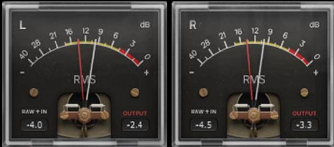
Die beiden VU-Pegelmeter des P455 bilden die Lautstärke präzise so ab, wie es unserem natürlichen Hören entspricht, denn sie messen den durchschnittlichen Eingangs- und Ausgangspegel über eine kurze Zeitspanne hinweg (RMS). Die numerischen Messwerte der Spitzenpegel in dBFS können Sie zudem von den beiden kleinen Sichtfeldern ablesen, die sich im unteren Fensterbereich befinden.
