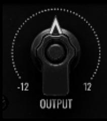
Mit dem OUTPUT-Regler kontrollieren Sie die Ausgangslautstärke im Signalpfad nach der Kompression. Diese Verstärkerstufe basiert auf der Bauweise eines Klasse A-Transformators, mit der Sie ihr Audiosignal
