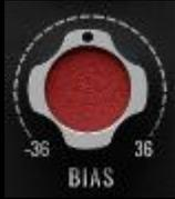
Mit dem BIAS-Regler kalibrieren Sie den Betriebspunkt des INPUT-Transformators und des LINE-Verstärkers. Die Bauteilkette läuft dadurch entweder heiß und mit weniger Headroom, oder kühl und mit mehr Headroom.
