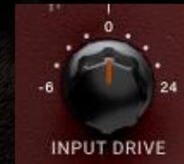
Mit dem INPUT DRIVE-Eingangungsverstärker erhöhen Sie die Lautstärke im Transformator und erzeugen *Harmonische geradzahligter Ordnung* (engl. *even order harmonics*). In der gemeinsamen Verwendung mit dem SATURATION-Schaltkreis entstehen ausgewogene Harmonische – und die schmeicheln jedem Klangmaterial.
