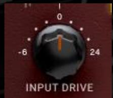
**INPUT DRIVE** ノブはトランスに追加の入力ゲインを送り込み、偶数の高調波を増加させます。これを **SATURATION** スライダーと一緒に使用して、素材に合った理想的な高調波バランスを調整します。
