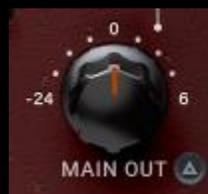
**MAIN OUT** ノブはクリーンなゲイン調整のためのものです。**MAIN OUT** を調整する際に **Shift** キーを押すと **INPUT DRIVE** が自動的に補正されます。
