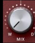
Mit der MIX / WET DRY-Schaltung mischen Sie die nasse (W) Tonspur mit der trockenen (D) Originaltonspur zusammen.
