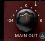
Mit dem MAIN OUT-Regler verstärken Sie den Ausgangspegel entweder digital-ungefärbt oder senken ihn ab.
