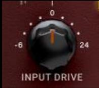
Mit dem INPUT DRIVE erhöhen Sie die Lautstärke im Transformator und erzeugen *Harmonische geradzahlgiger Ordnung* (engl. *even order harmonics*). Gemeinsam mit der SATURATION entstehen ausgewogene
