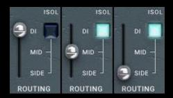
Alterna l'elaborazione tra mono/stereo (DI), mid (MID) o side (SIDE). Le opzioni mid e side sono disponibili solo quando il plugin rileva un segnale stereo.
