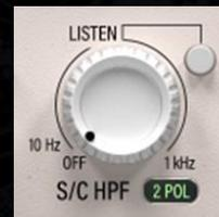
Mit S/C HPF nehmen Sie das in die S/C-Detektoreinheit (engl.: *internal sidechain*) integrierte *Hochpassfilter* in Betrieb. Auf den eigentlichen Klang der bearbeiteten Tonspur hat das Filter keinen Einfluss.
