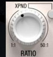
Die RATIO bestimmt den Umfang, oder besser gesagt, die Stärke der vom Kompressor angewandten Pegelreduktion – sobald das in die S/C-Detektoreinheit eingehende Signal den *Schwellenwert* überschreitet.
