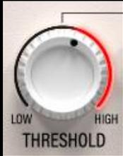
Mit THRESHOLD stellen Sie den *Schwellenwert* des Kompressors ein. Sobald ein Signal in der S/C-Detektoreinheit – dem *sidechain detector*, wie es im Englischen heißt – diesen Grenzwert überschreitet, beginnt der Kompressor mit seiner Arbeit. Die Stärke der Dynamikänderung ist zudem abhängig von RATIO.
