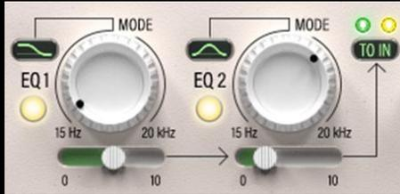
Die beiden multifunktionalen EQ-Bänder können zwei Signale gleichzeitig bearbeiten: Das in die S/C-Detektoreinheit eingehende Signal (TO SC) und das vor einem dynamischen Eingriff die Bearbeitungskette durchlaufende Signal (TO IN).
