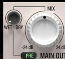
MAIN OUT verstärkt den Pegel des Ausgangssignals.
