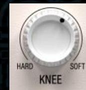
KNEE legt den Neigungsgrad der RATIO-Kurve fest und bestimmt, wie weich, oder anders ausgedrückt, wie schnell der Übergang des unkomprimierten zum komprimierten Signal erfolgt. In der SOFT-Einstellung steigt die Übergangs- oder Zeitkurve allmählich an, um schließlich die auf den Kompressor wirkende RATIO zu erreichen. In der Einstellung HARD setzt die durch RATIO bedingte Kompressionsstärke sofort ein.
