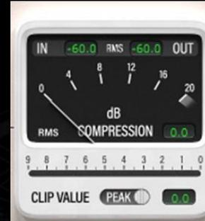
dB COMPRESSION ist das wichtigste Messinstrument des RMS-Kompressors. Anhand der Ballistik der virtuellen Nadel können Sie von diesem Sichtfeld schnell und bequem den Umfang der dynamischen Pegelreduktion ablesen (Im Englischen *gain reduction* und abgekürzt *GR*).
