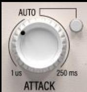
ATTACK legt die Zeit fest, die benötigt wird, eine gewünschte Pegeländerung vollständig zu erreichen. Der Schaltkreis befindet sich in wechselseitiger Beziehung mit THRESHOLD und RATIO.
