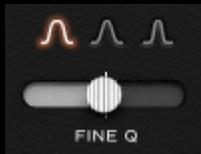
El factor Q define el ancho y la pendiente del impulso/corte. El selector LOW Q permite elegir uno de los tres diseños Q proporcionales ajustados individualmente.
