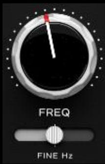
Cada posición escalonada en el potenciómetro FREQ presenta un punto óptimo meticulosamente elegido que generalmente funcionará bien con cualquier fuente de audio.
