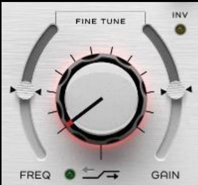
Der High-Shelf-Regler selektiert eines der definierten Signature-High-Shelf-Filterprofile.
