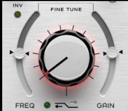
Der gesteppte Low-Shelf-Regler ruft definierte Signature-Eckfrequenzen, Flanken, Verstärkungsschritte und Kurveneigenschaften auf, die nach dem Höreindruck abgestimmt wurden und aus wechselseitig angeglichenen Parameterkombinationen bestehen. Dabei behält jede Stufe das Timbre des Ausgangsmaterials bei.
