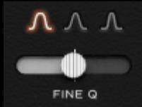
Der Q-Faktor definiert die Filtergüte/Bandbreite der Anhebung oder Dämpfung. Mit dem LOW Q-Wählschalter selektiert man eine von drei Proportional-Q-Glocken.
