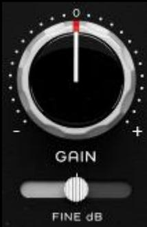
Der GAIN-Regler ist in vorgegebene Pegelstufen unterteilt.
