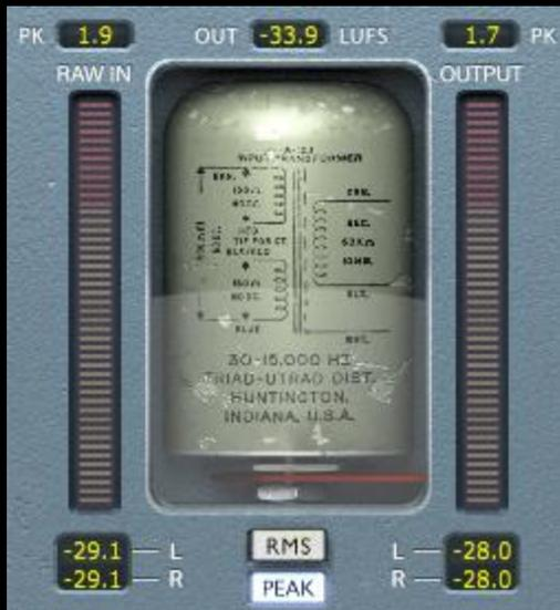
La medición muestra varias opciones de información, incluidas las mediciones LUFs (unidades de sonoridad relativas a full scale), las mediciones dBFS PK (decibelios en relación con la retención del pico a full scale) y los medidores y mediciones de barras RMS / PEAK RMS (Root-Mean-Square) conmutables.
