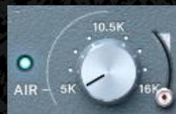
El filtro shelf AIR es un high shelf cuidadosamente ajustado y diseñado para desenmascarar suavemente los detalles y la claridad de alta frecuencia. El control deslizante de realce varía en intensidad de
