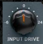
El potenciómetro INPUT DRIVE empuja la ganancia de entrada adicional a través del transformador, lo que aumenta los armónicos de orden par. Usa esto en conjunto con el control deslizante de saturación para marcar un equilibrio armónico ideal que favorezca su material.
