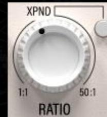
RATIO détermine le facteur par lequel le gain est ajusté une fois que le signal S/C franchit la threshold. La réduction du gain (gain en mode XPND) est appliquée au signal d'entrée.
