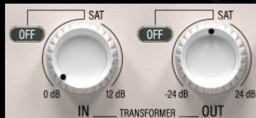
Les boutons de gain T. IN et T. OUT permettent de régler le gain avant et après le traitement dynamique soit numériquement de façon propre et
