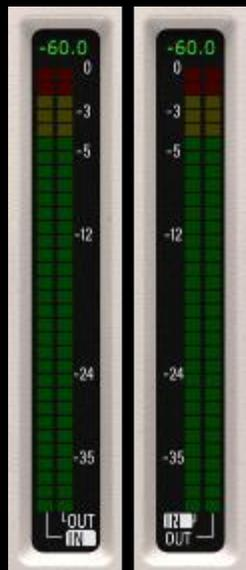
Les indicateurs LED affichent simultanément les niveaux d'entrée et de sortie de crête et de valeur efficace, la valeur efficace étant représentée par le bloc LED "solide" continuellement mis à jour dans la partie principale de l'indicateur, et la valeur de crête étant représentée par le voyant LED "maintenu", qui apparaîtra toujours au-dessus du bloc RMS.
