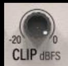
On ne passe pas. Le potard CLIP règle la valeur efficace dBFS (décibels par rapport à la pleine échelle) à laquelle le clipper analogique écrête le signal avec une transparence magnifique et une
