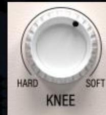
Le KNEE est la pente (douceur de la transition) du ratio. En réglage SOFT, le ratio est progressivement augmenté pour atteindre la valeur de ratio définie, tandis qu'en réglage HARD, la valeur du ratio est appliquée immédiatement.
