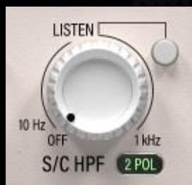
S/C HPF applique un filtre passe-haut au circuit du détecteur. Ce filtre n'affecte pas directement le son du signal traité. La pente du HPF peut être réglée à l'aide du commutateur 1 POL / 2 POL situé à droite de l'étiquette S/C HPF. L'option 1 POL donne une pente de filtre de 6 dB/oct, tandis que l'option 2 POL donne une pente
