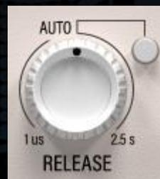
Le paramètre RELEASE contrôle le temps nécessaire pour revenir au niveau de gain non affecté lorsque le signal tombe en dessous du threshold. Si la fonction AUTO est activée, le temps de release est continuellement et dynamiquement déterminé par Abyss. La vitesse du temps de relâchement, qui dépend du programme, peut être influencée en réglant le bouton RELEASE. Les valeurs vont de -10 à 10 lorsque la fonction AUTO est activée.
