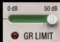
Limite la réduction maximale du gain à la valeur spécifiée. Sans ce réglage, le compresseur ou l'expandeur/gate applique la réduction de gain déterminée par le ratio et le threshold sans restriction. Avec ce réglage, la réduction de gain ne dépassera pas cette valeur.
