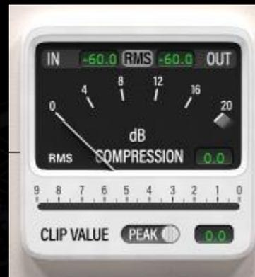
La fenêtre principale de l'indicateur de réduction de gain dB COMPRESSION montre la réduction de gain RMS (Root-Mean-Square) appliquée au signal, comme l'indique l'aiguille balistique.
