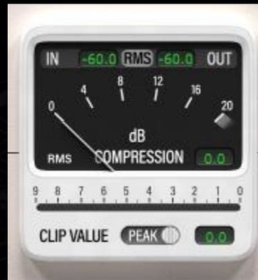
La ventana principal del medidor de reducción de ganancia dB COMPRESSION muestra la reducción de ganancia RMS (Root-Mean-Square) aplicada a la señal según lo indicado por la aguja balística.
