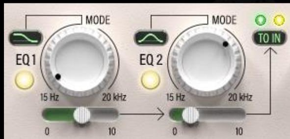
Dos bandas de ecualización multifuncionales se pueden utilizar para alterar simultáneamente la señal enviada al circuito detector
