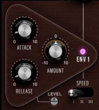
El seguidor de envolvente extiende las capacidades de filtrado de la frecuencia de corte, la resonancia y la pendiente o la banda de filtro NOTCH/PEAK, convirtiéndolos en filtros dinámicos.
