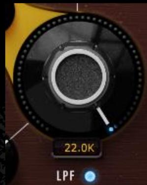
El knob de frecuencia de corte LPF fija el punto en el que el filtro pasa bajo empieza a funcionar.
