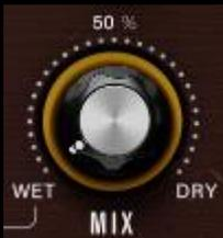
El knob MIX permite mezclar una cantidad deseada de señal seca con la señal húmeda procesada.
