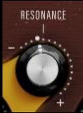
El knob de resonancia del HPF se utiliza para añadir feedback positivo o para quitar o suavizar la curva de transición.
