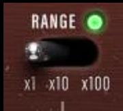
El selector RANGE permite que un rango restringido sea aplicado al knob de frecuencia de filtro de banda NOTCH/PEAK respectivo.
