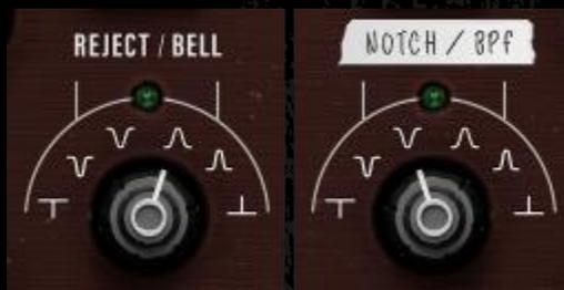
El selector conmutable de filtro de banda NOTCH/PEAK permite la elección de tres filtros notch y tres filtros pasa banda.
