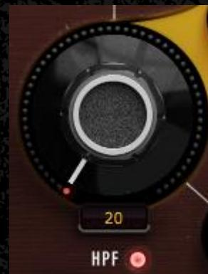
El knob HPF de la frecuencia de corte fija el punto desde donde el filtro pasa alto empieza a funcionar.
