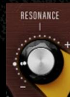
Mit „LPF-RESONANCE“ erhöhen Sie das Feedback des Tiefpassfilters mit positiven Einstellungen oder verringern es mit negativen Einstellungen, was die an der Eckfrequenz anliegende Filter-Kurve abrundet.
