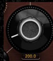
Mit dem „NOTCH/PEAK“-Frequenzregler“ stellen Sie die Eckfrequenz der „Notch“- oder „Peak“-Bandfilter ein. Die verfügbaren Filterformen wechseln Sie mit den „Filtertyp“-Schaltern.
