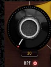
„HPF“ („highpass filter“) legt die „Cutoff“-Frequenz, also die Eckfrequenz, des Hochpassfilters fest.
