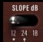
Mit dem Wahlschalter „HPF SLOPE dB“ ändern die Steilheit der Filterflanke des Hochpassfilters.
