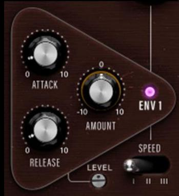
Der Hüllkurvenfolger („ENV“) erweitert die Filteroptionen der Eckfrequenz-Regler, von „RESONANCE“ und „SLOPE“. Er macht aus allen verfügbaren, in der Voreinstellung unbeweglichen Filtern, dynamische Filter.
