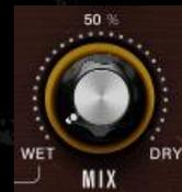
Mit dem „MIX“-Regler bestimmen Sie das Mischverhältnis vom trockenen („DRY“) zum nassen („WET“) Signal.
