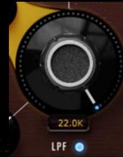
„LPF“ („lowpass filter“) legt die „Cutoff“-Frequenz, also die Eckfrequenz, des Tiefpassfilters fest.
