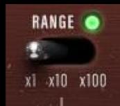
Mit „RANGE“ weisen Sie den beiden „NOTCH/PEAK“-Bandfiltern verschieden große Frequenzbereiche zu. Deren Bewegungsspielraum wird eingegrenzt und das Maß der Filterkontrolle wird erhöht.
