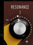
Mit der „HPF RESONANCE“ erhöhen Sie das Feedback des Hochpassfilters mit positiven Einstellungen, oder verringern es mit negativen Einstellungen, was die an der Eckfrequenz anliegende Filterkurve abrundet.
