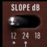
Mit dem Wahlschalter „LPF SLOPE dB“ ändern die Steilheit der Filterflanke des Tiefpassfilters.
