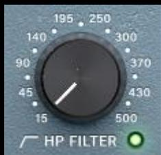
El filtro pasa alto característico cuenta con una pendiente de 12 dB/oct y un rango de frecuencia de 15 Hz a 500 Hz. Utilízalo en conjunto con el low shelf para influir en el enfoque, el peso y la calidez del extremo inferior de cualquier señal.
