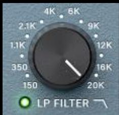
El filtro pasa bajo característico presenta una pendiente de 12 dB/oct y un rango de frecuencia de 150 Hz a 20 kHz a una frecuencia de muestreo de 44,1 kHz, de 150 Hz a 22 kHz a una frecuencia de muestreo de 48 kHz o de 150 Hz a 40 kHz a frecuencias
