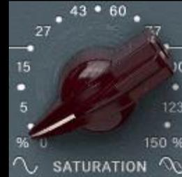
El potenciómetro de saturación influye en la cantidad de saturación aplicada a la señal. Gradualmente desarrolla una compleja matriz de armónicos que se genera no solo en función de la señal, sino también mediante un gráfico de saturación autogenerado.
