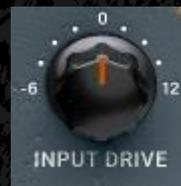
El potenciómetro INPUT DRIVE empuja la ganancia de entrada adicional a través del transformador, lo que aumenta los armónicos de orden par. Usa esto en conjunto con el control deslizante de saturación para marcar un equilibrio armónico ideal que favorezca su material.
