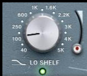
Die innovative Bauweise des LO SHELF (Niederfrequenzfilter mit Kuhschwanzcharakteristik) ist mit einer musikalisch angelegten Anhebung bestückt, die zwischen 40 Hz und 5 kHz rangiert.
