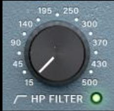
Das Hauptmerkmal des charakteristischen Hochpassfilters ist eine 12 dB/Okt Hüllkurve im Frequenzbereich zwischen 15 Hz und 500 Hz. Kombinieren Sie es zusammen mit dem LO SHELF um Fokus, Umfang und Wärme des Tieftonbereichs ihrer Signale zu beeinflussen.
