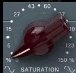
Der Sättigungsregler bestimmt die Menge der auf das Signal einwirkenden Sättigung. Dadurch bauen sich allmählich komplexe Obertonmuster auf. Diese basieren sowohl auf dem Originalsignal als auch auf einer sich selbstgenerierenden Sättigungsabbildung.
