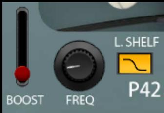
Die innovative Bauweise des L.SHELF (Niederfrequenzfilter mit Kuhschwanzcharakteristik) ist mit einer musikalisch ausgerichteten Anhebung (BOOST) bestückt, die zwischen 40 Hz und 5 kHz rangiert. Auf den angehobenen Signalanteil
