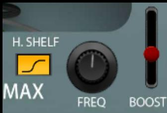
Das H.SHELF (Hochfrequenzfilter mit Kuhschwanzcharakteristik) ist ähnlich innovativ beschaffen wie das L.SHELF und fußt auf einer ultra-weichen Anhebung (BOOST), die im Frequenzbereich zwischen 150 Hz und 5 kHz rangiert. Dem
