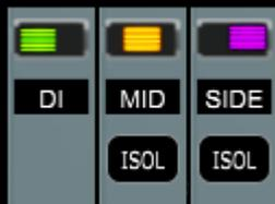
Der Schalter ändert die Bearbeitung des jeweiligen Signalpfades auf Mono/Stereo (DI), Mitten (MID) oder Seite (SIDE). Die Mitten- und Seitenfunktionen sind nur im Stereobetrieb verfügbar.
