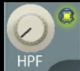
Das Hauptmerkmal des charakteristischen Hochpassfilters ist eine 12 dB/Okt Hüllkurve im Frequenzbereich zwischen 15 Hz und 500 Hz. Kombinieren Sie es zusammen mit dem L.SHELF um Fokus, Umfang und Wärme des Tieftonbereichs ihrer Signale zu beeinflussen.
